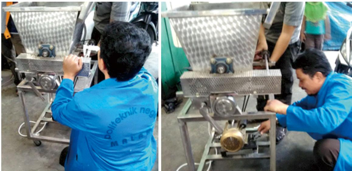
Gambar 7-8. Penyetelan dan pemasangan motor
