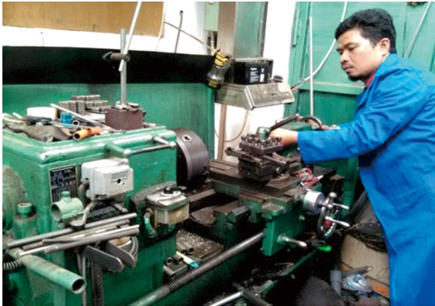
Gambar 6. Proses mesin bubut
